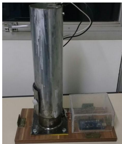
Figura 4 - Planta didática de um Forno Industrial.
